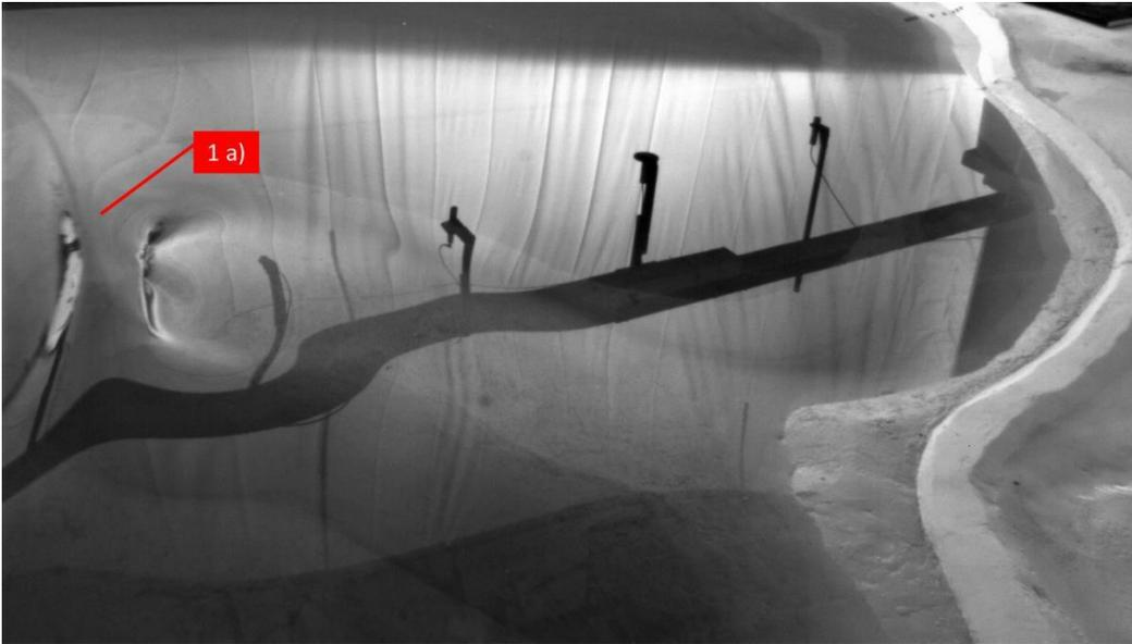
Abbildung 4.1: Wellenausbreitung im Modellzustand A, Bereich nach der Wellenerzeugung
